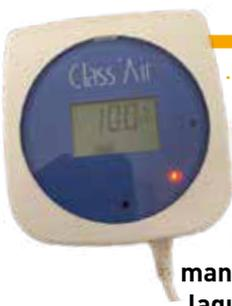
**D**epuis janvier 2021, les salles de maternelle et de primaire sont dotées d'un « Class'air ». Ce boîtier de mesure de la qualité de l'air intérieur. Il permet d'effectuer différentes mesures de manière instantanée, quelle que soit la pièce dans laquelle il est placé.
