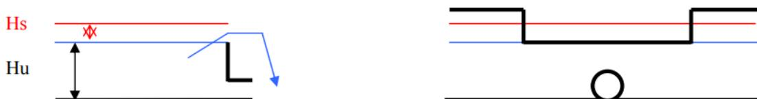
Le dispositif de rétention doit disposer d'une hauteur d'eau supplémentaire  $H_s$  au-delà de  $H_u$  pour permettre à la surverse d'évacuer le débit supérieur au degré de protection de l'ouvrage ( $T=20$  ans).
