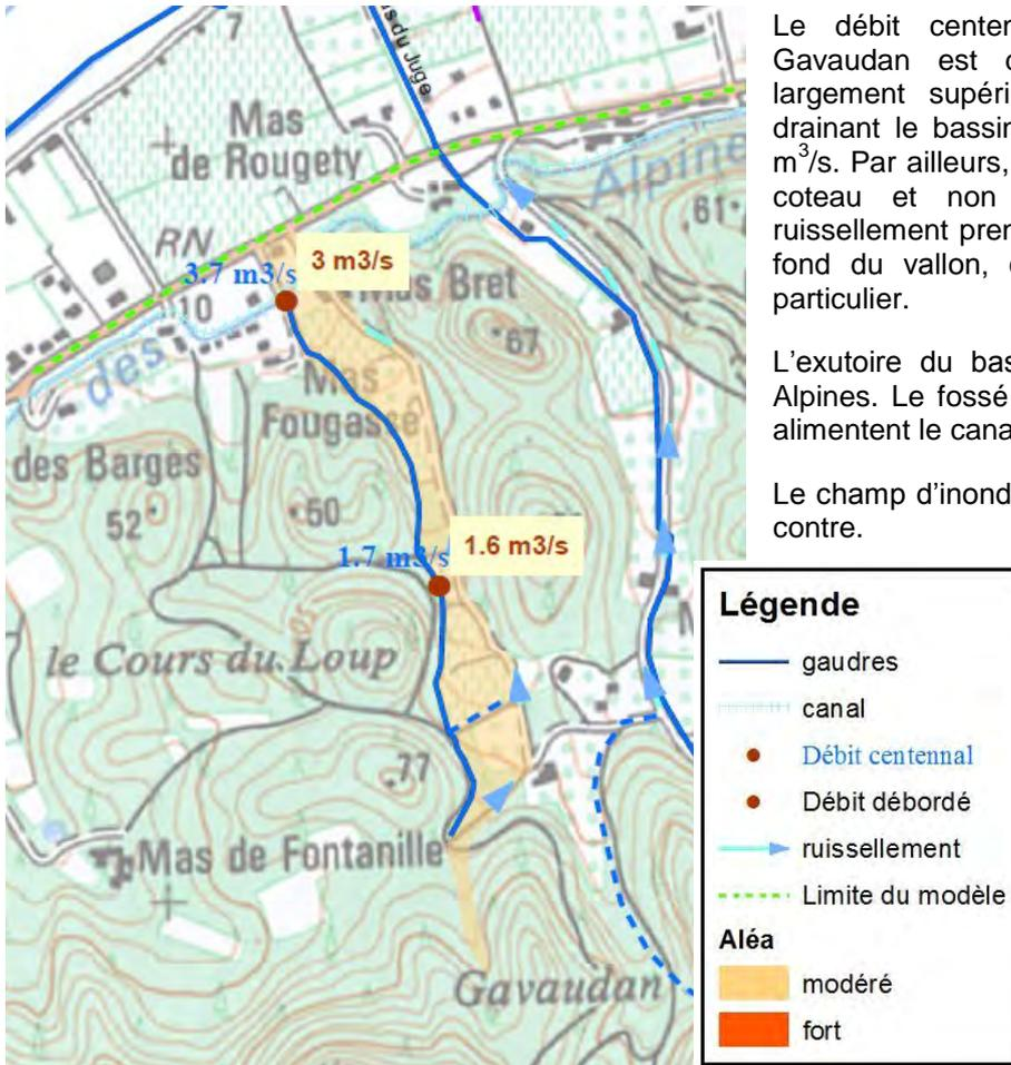
Le débit centennial du bassin versant du Gavaudan est de  $3.7 \text{ m}^3/\text{s}$ . Ce débit est largement supérieur à la capacité du fossé drainant le bassin versant, comprise  $0.1$  et  $0.7 \text{ m}^3/\text{s}$ . Par ailleurs, le fossé est localisé à flanc de coteau et non en fond de vallon et le ruissellement prend place sur toute la largeur du fond du vallon, et sur le chemin d'accès en particulier.
