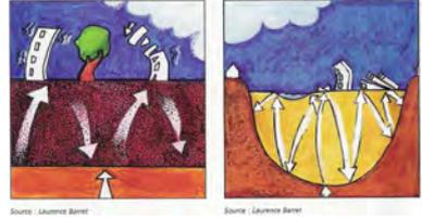
L'observation post-sismique a montré en effet que les conditions de sols en sub-surface (dans les 100 premiers mètres de la croûte terrestre en général) pouvaient augmenter l'agressivité d'un séisme.
